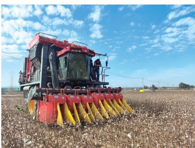
锭采用了螺旋锥齿轮的传动设计,减轻了传动负载,使其更加持久耐用,加上摘锭齿形齿面的独特设计,使其净率更高,对棉花纤维的破坏更小。产品在采摘核心指标上占有一定优势。
