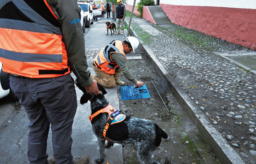
6月27日,在智利圣地亚哥,工作人员标记一处漏水地点。工作犬Suki每天在智利首都圣地亚哥漫步,用她强大的嗅觉搜寻地下破裂的管道,或可为这座城市节约数百万升水。新华社/法新
