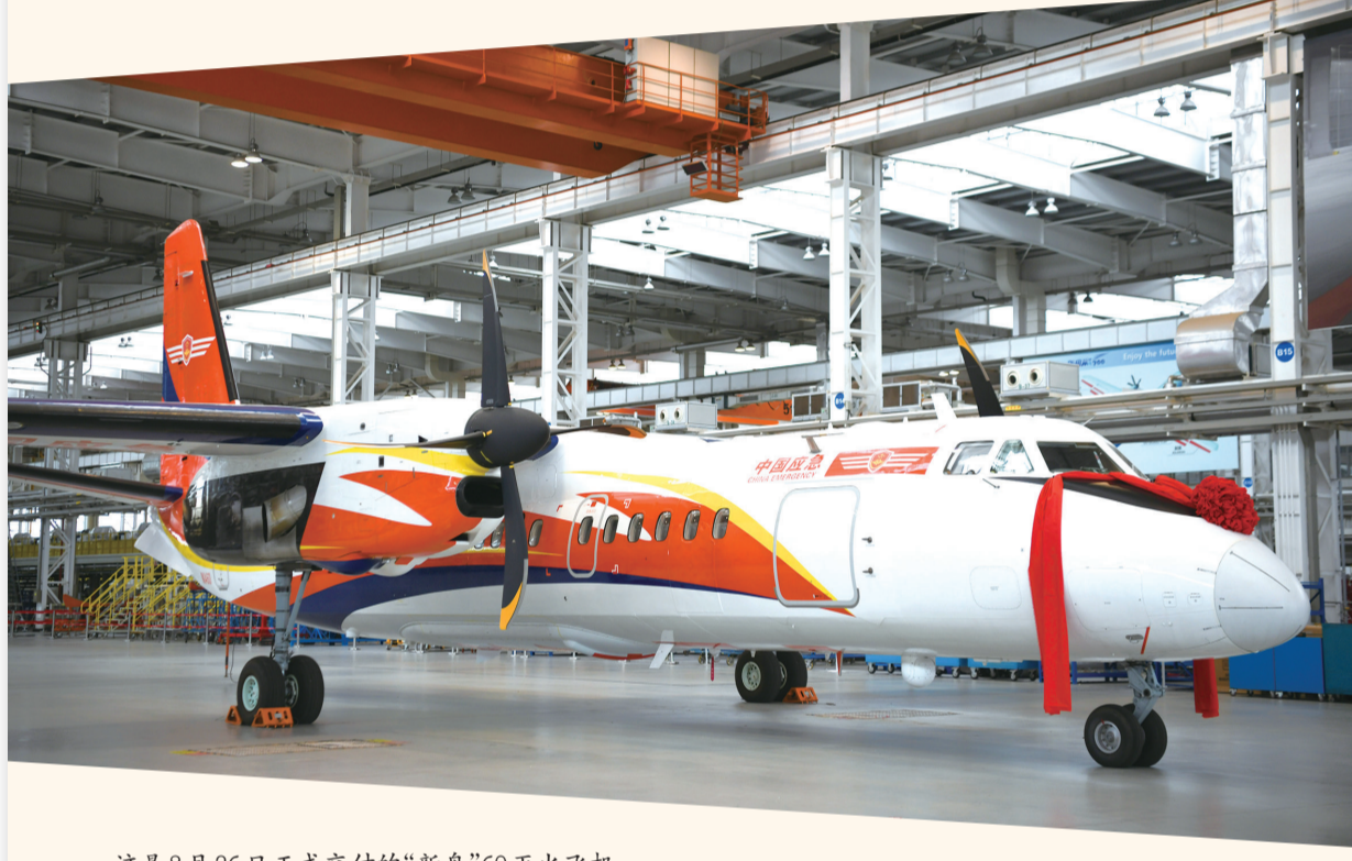
这是8月26日正式交付的“新舟”60灭火飞机。 8月26日,由中国航空工业集团自主研发设计的两架“新舟”60灭火飞机在西安正式交付应急管理。 “新舟”60灭火飞机是一款具有自主知识产权的大中型固定翼应急救援飞机,最大载水量6吨,最大人员运输数量28人,最大货物运输重量3.7吨。飞机集投水灭火、火情监测、通信指挥、人员运输、物资运输等多功能于一体,具备快速响应、复杂地形作业等优势。 新华社发
