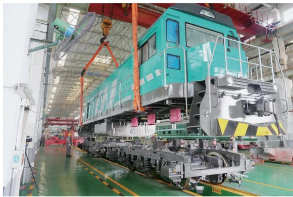
8月29日,中车戚墅堰公司研制的1500千瓦功率等级氢燃料混合动力机车正式下线。与传统内燃机车相比,这款机车的能量利用效率提升超过80%,加氢时间仅需25-30分钟,能有效保证机车作业能力和续航里程。
