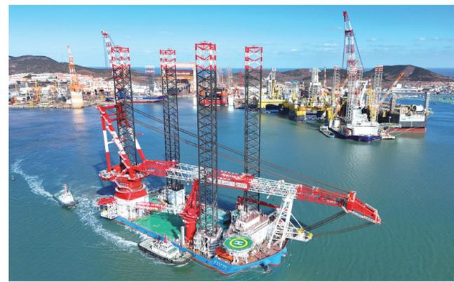
试航中的“铁建风电2000”海上风电安装船(12月8日摄,无人机照片)。12月28日,第四代自升式风电安装船“铁建风电2000”在中集来福士山东烟台建造基地交付。该船装备了起吊能力达2000吨的全回转起重机,可在水深80米的海域进行20兆瓦以上各型海上风机的安装施工。新华社发
