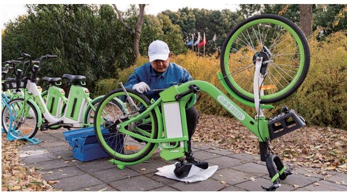
位于汉江路的永安行智能科技园区内,专员维修工朱士国也在车间忙碌。冬季是维保高峰期,多年来,他和团队经手维修的车辆不计其数。朱士国说,每天有近百辆助力自行车从各个站点被拉回仓库维修,最普遍的问题是控制元件损坏导致车辆不助力,骑行时感觉较沉。遇到这种问题时就需将车辆拆开进行维修了。
