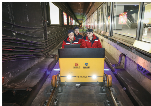
图为黄嘉诚(左一)和同事们驾驶着“铁帅”为地铁轨道开展检查
