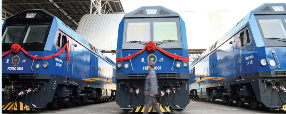
工况下油耗降低13%以上。机车搭载柴油机故障预测与健康管理系统,运行过程中可以对机车进行全方位监测。机车采用R12V280ZJ型柴油机,
