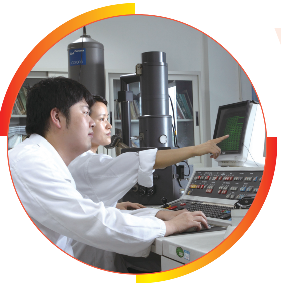
中车戚墅堰机车车辆工艺研究所股份有限公司司法鉴定所在微量鉴定中做扫描电镜图谱分析
