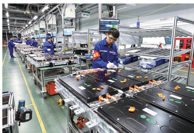
在上汽时代动力电池系统有限公司车间,工人在安装新能源汽车动力电池系统。
