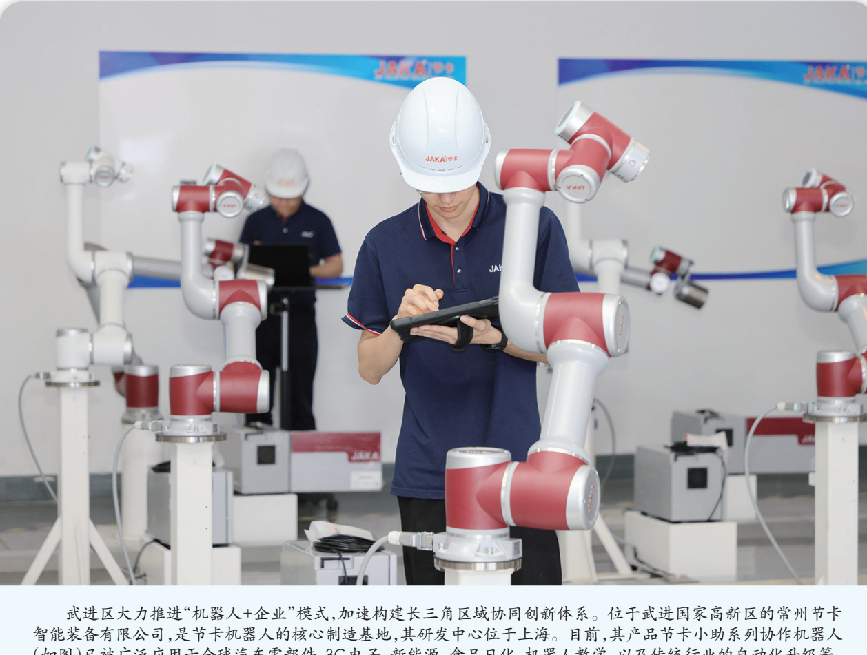
武进区大力推进“机器人+企业”模式,加速构建长三角区域协同创新体系。位于武进国家高新区的常州节卡智能装备有限公司,是节卡机器人的核心制造基地,其研发中心位于上海。目前,其产品节卡小助系列协作机器人(如图)已被广泛应用于全球汽车零部件、3C电子、新能源、食品日化、机器人教学,以及传统行业的自动化升级等,并获专利超过200项。 徐洋 高岷图文报道
