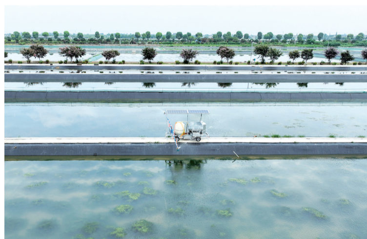
凯耀农业的蟹塘内,智能化轨道投饲机正均匀撒播饲料。
