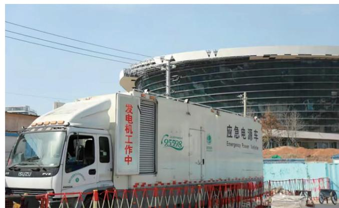
体的车载式可移动分布式电源,接入配电网后,就成为一个大“充电宝”,为线路上的用户提供电力。溧阳供电在去年8月成功运用“不停电作业+中压发电车”模式开展电网施工后,在此基础上不断探索各类
